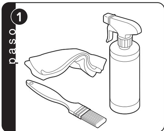
Prepare una solución con jabón en la que haya una medida de detergente líquido y una medida de agua. Necesitará una botella con pulverizador, un cepillo o paño para aplicar la solución en las uniones.
